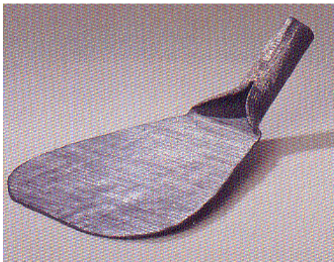
uit plaat lood samengestelde lood "hamer" om lood zonder deuken vlak te slaan
